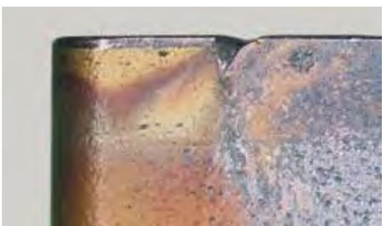
Зазубрина на максимальной глубине резания.
