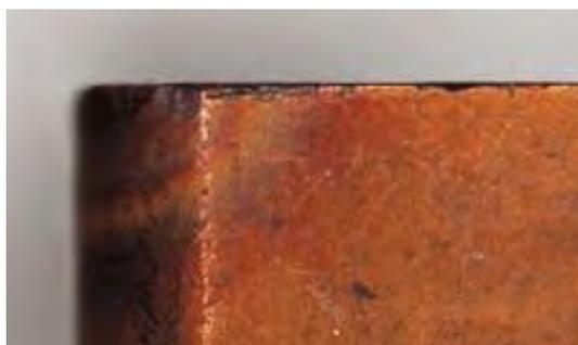
Выкрашивание - результат чрезмерных механических нагрузок на режущую кромку.
