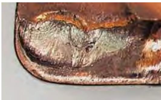
Причина образования лунок - горячая стружка, которая движется по передней поверхности вставки.
