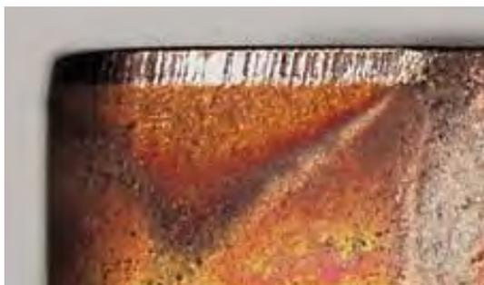
Абразивный износ задней поверхности, нормальный вид износа после стандартного машинного времени использования.
