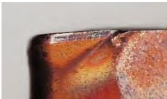
Налипание обрабатываемого материала происходит в связи с нарушением процесса удаления стружки из-за слишком низкой температуры.
